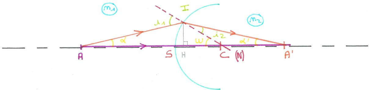
Dans l'approximation de GAUSS, les angles  $i_1$ ,  $i_2$ ,  $\alpha$ ,  $w$  sont suffisamment petits et H et S peuvent être considérés confondus.
