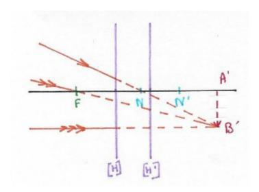
Pour construire l'image d'un objet AB virtuel, il suffit de construire la marche de 2 rayons particuliers se dirigeant vers B. L'intersection des 2 rayons donne B'.
