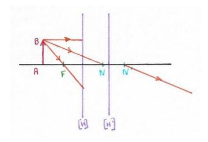
Pour construire l'image d'un objet AB réel, il suffit de construire la marche de 2 rayons particuliers issus de B. L'intersection des 2 rayons émergeant donne B'.
