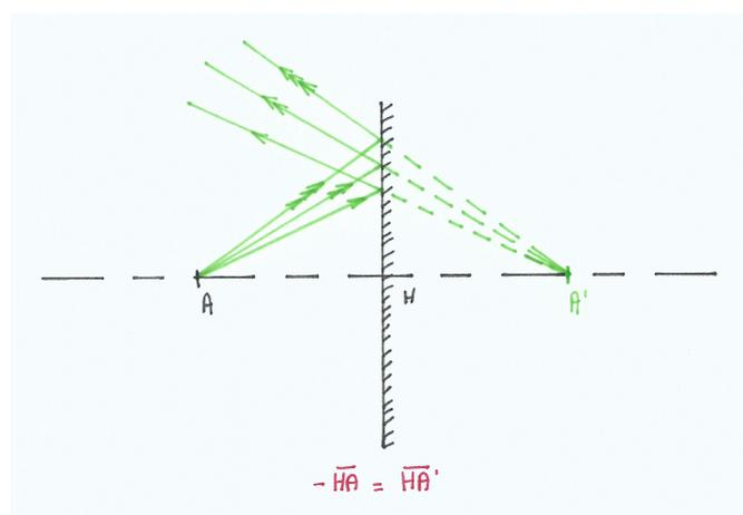
Les rayons semblent provenir d'un même point. L'image est **virtuelle**, directement observable à l'oeil. L'image d'un point à travers un miroir est unique.
