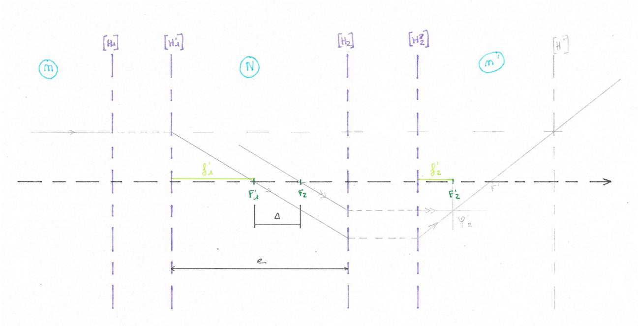
Si l'ensemble est assimilable à un syst.centré alors un rayon incident // à l'axe ressort en passant ou semblant provenir de  $F'$
