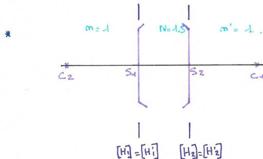
\* Les systèmes centrés sont les 2 dioptries, les plans principaux  $[H_1], [H_1']$  et respectivement  $[H_2]$  et  $[H_2']$  sont confondus avec le sommet des dioptries.
