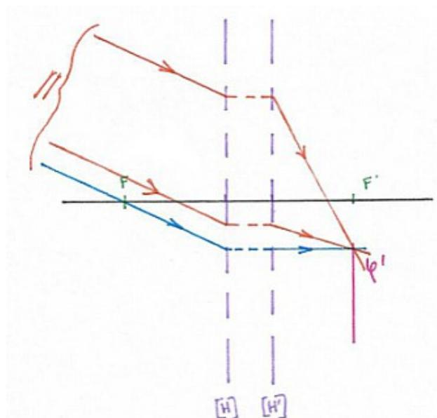
Deux rayons incidents // entre eux ressortent du système optique en passant par le même foyer secondaire image ( $\phi'$ ) ou en semblant provenir du même foyer secondaire image.
