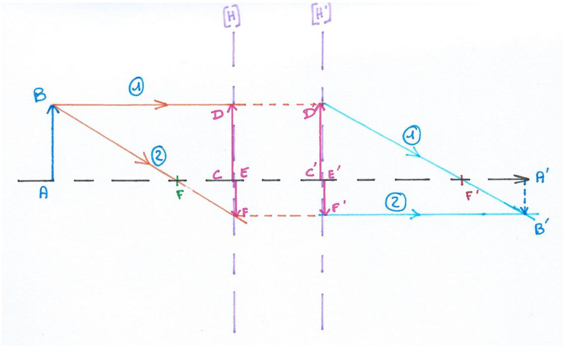
Pour construire l'image d'un objet AB à travers un système centré, on construit la marche de 2 rayons incidents issus de B si AB est réel ou allant vers B si AB est virtuel. L'un de ces rayons est parallèle à l'axe, on cherche son intersection avec le plan [H], il ressort en passant par F' en coupant [H'] à la même hauteur.
